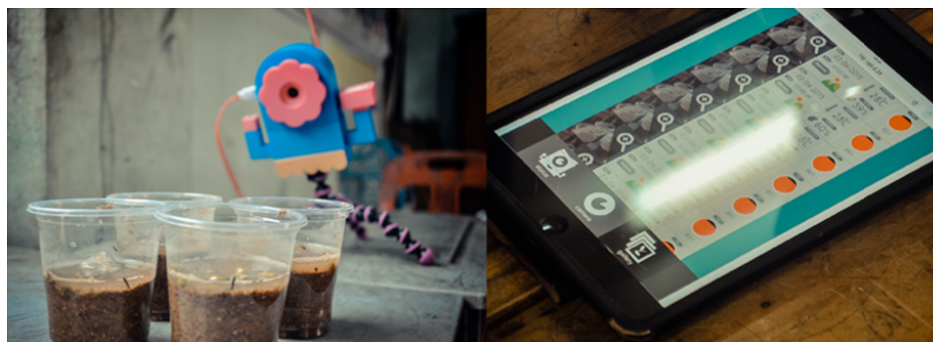
FIGURE 4.6 – Dispositif OBSY . Collecte de données sur le développement des plantes et visualisation des résultats sur une tablette (Putjorn et al., 2018).
