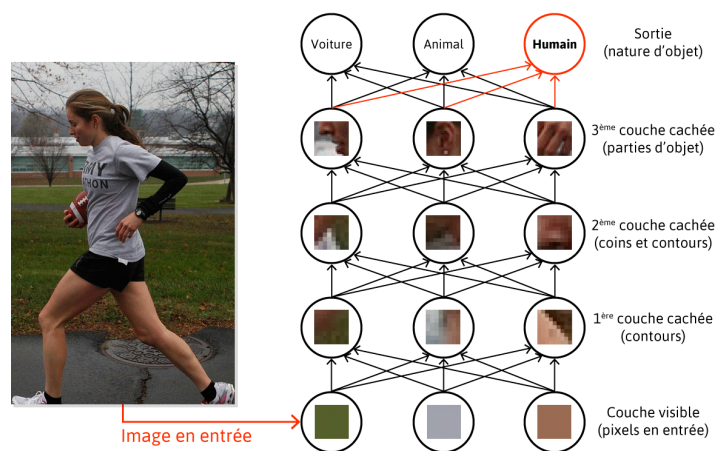
FIGURE 2.7 – Vision artificielle avec l'apprentissage profond. Adapté de Goodfellow, Bengio, et Courville (2017).
